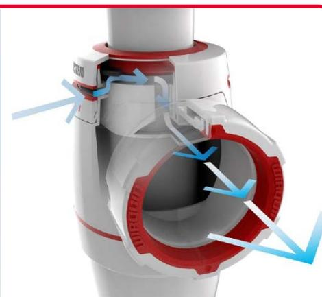
Quand une dépression est créée dans les tuyaux, cela aspire l'air mais aussi l'eau contenu dans le siphon (la garde d'eau).
