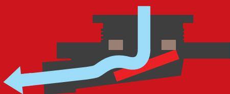
L'eau de la douche exerce une pression supérieure à la force magnétique des aimants. Le clapet magnétique mobile s'ouvre pour permettre l'écoulement. Plus le débit de l'eau augmente au cours de la douche, plus le clapet mobile s'ouvre.
