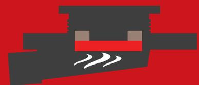
La force magnétique assure un maintien permanent du clapet qui, combiné à la garde d'eau de 1 cm, stoppe toute remontée d'odeur.
