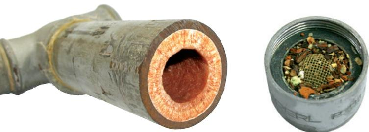
Le sable, la rouille, les graviers endommagent et engorgent vos installations sanitaires comme par exemple les conduites d'eau, la robinetterie, les chauffe-eau, les douches ...
