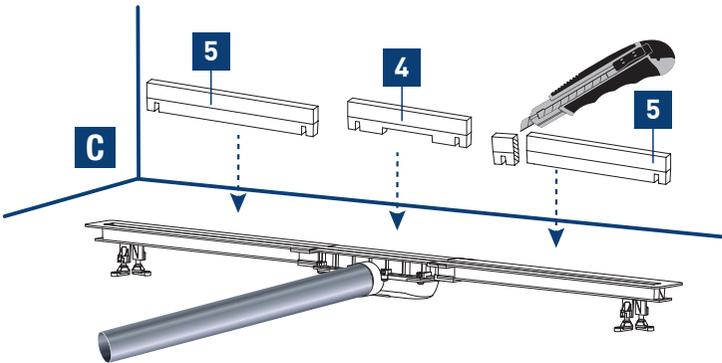
Placer la cale centrale d'obturation en polystyrène.
