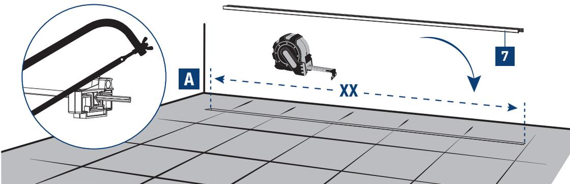
Assembler les supports et les positionner sur les barettes de finition.
