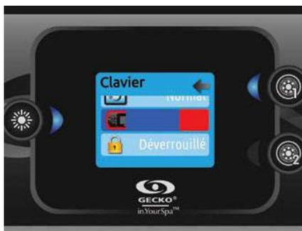
Avec le in.k500 équipé du module sélection de couleur de contour: Si l'option « Rétroéclairage RGB » est activée dans la configuration du spa, une nouvelle option s'affichera pour permettre de choisir la couleur de la lumière du contour.
