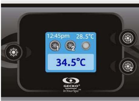
Le bouton n°1 démarre ou arrête les pompes n°1 et n°2. Le bouton n°2 démarre ou arrête la pompe n°3 et la pompe n°4/soufflerie.
