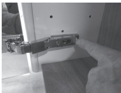
Démontage charnière Dismantling of the hinge Zerlegung des Scharniers
