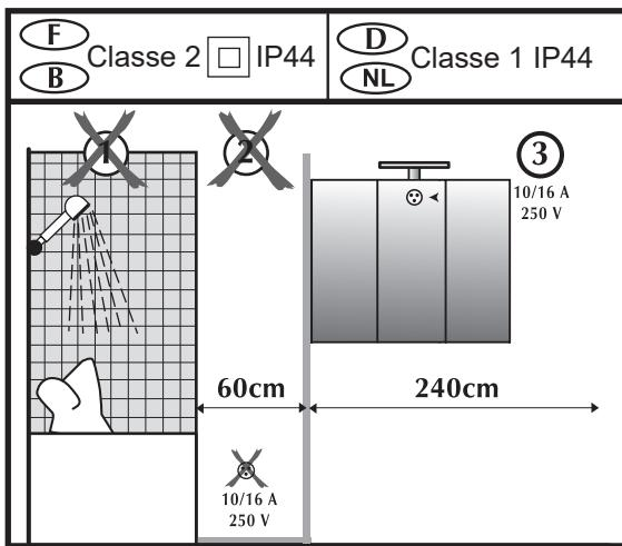
Le fabricant préconise que l'installation et le branchement soient réalisés par un technicien qualifié. Avertissement : ce produit doit être installé uniquement dans le volume 3 d'une salle de bain, conformément aux exigences de la norme française d'installation électrique NF C 15-100.
