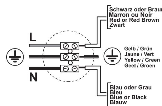
Cet appareil doit être raccordé à l'alimentation par l'intermédiaire d'une boîte de raccordement Classe 2, IP44, conformément à la norme NFC 15-100 et UTE C 15-801, et dont les bornes ont une section nominale égale à 2,5 mm. Une fois installé en position d'utilisation, les câbles de raccordement ne doivent être ni visibles, ni accessibles, ni contraints.
