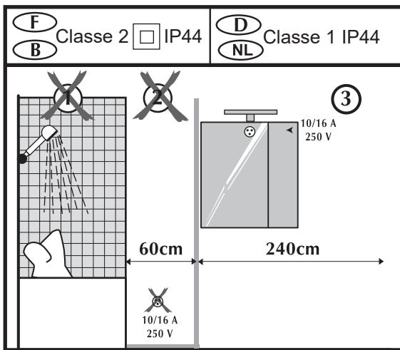
**F** Le fabricant préconise que l'installation et le branchement soient réalisés par un technicien qualifié. Avertissement : ce produit doit être installé uniquement dans le volume 3 d'une salle de bain, conformément aux exigences de la norme française d'installation électrique NF C 15-100.
