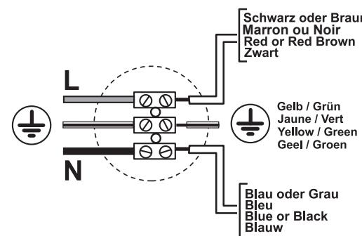
Cet appareil doit être raccordé à l'alimentation par l'intermédiaire d'une boîte de raccordement Classe 2, IP44, conformément à la norme NFC 15-100 et UTE C 15-801, et dont les bornes ont une section nominale égale à 2,5 mm. Une fois installé en position d'utilisation, les câbles de raccordement ne doivent être ni visibles, ni accessibles, ni contraints.
