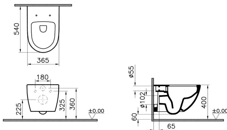
**Description:** Sento Pack WC susp. Vitra Flush 2.0, 54 cm, abattant Slim Duropl., fermeture douce, fixation par le haut, charn. en en acier inox., fix. V-Fit 2.0, cap. de chasse d'eau 3/6 litres.
