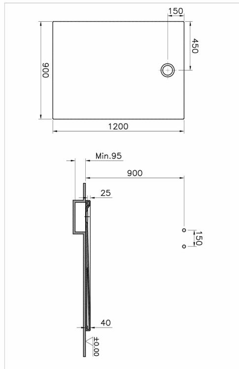
**Description:** Lagoon receveur ultra plat en céramique, 120x90cm, classification antidérapant A/PN12, à poser/encastrer, blanc haute brillance, bonde  $\varnothing$  90 mm, sans système d'écoulement. Important: Un décaissement dans le sol est nécessaire!
