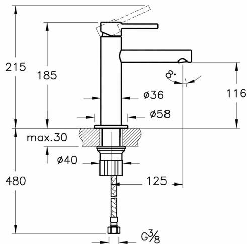
**Description:** Origin mitig. lavabo,s.garn. de vidage, mono trou, haut. 185 mm, saillie 125 mm, haut. goulot 116 mm, mouss.integr., cart.a.disques céram., racc. fl.,kit de montage, surface cuivre. Écon. d'eau : Limite 5 l / min.. Kit siphon pas inclus.
