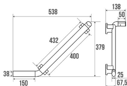
Tube elliptique 38x25 mm en aluminium, cache-fixations en polymère.
