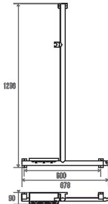
Tube elliptique 38 x 25 mm en aluminium noir mat. Embout en résine de synthèse noir brillant.
