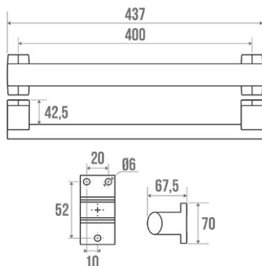
Tube elliptique 38 x 25 mm en aluminium noir mat. Cache-fixations en résine de synthèse noir brillant.
