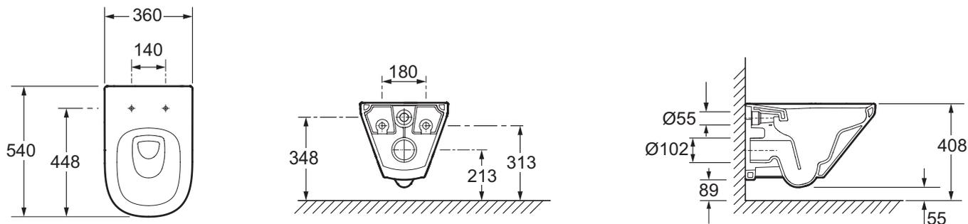
Descriptif CCTP : Cuvette suspendue SANS BRIDE. E77725. Collection : MODERN LIFE. DIMENSIONS : 54 x 36 cm. POIDS : 55 kg. MATÉRIAU : Céramique. TYPE D'INSTALLATION : Suspendu. CONSOMMATION D'EAU : Standard 3/6 L. HAUTEUR : Standard. TYPE DE BRIDE : Sans bride. MÉCANISME DE CHASSE : double chasse. GARANTIE DE LA CÉRAMIQUE : 10 ans. CONDITIONNEMENT : Carton. FIXATION DE LA CUVETTE : invisibles.
