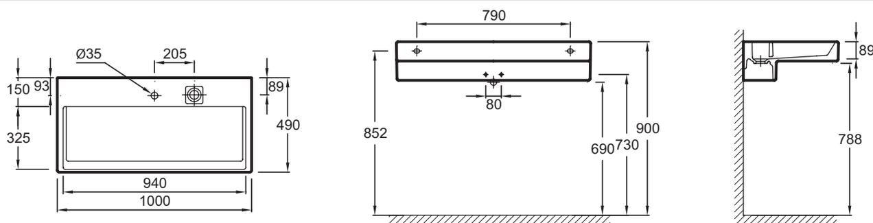
Descriptif CCTP : Plan-vasque 100 cm, bandeau LED. EXC9112. Collection : TERRACE. DIMENSIONS : 100 x 49 cm. POIDS : 31,5 kg. MATÉRIAU : Céramique. TYPE D'INSTALLATION : Autoportant ou peut être monté sur un meuble spécifique. PERCEMENT ROBINETTERIE : 1 trou. CONFIGURATION : Standard. TROP-PLEIN : Avec trou de trop-plein. NOMBRE DE VASQUES : 1 cuve. LIVRÉ AVEC : Bandeau LED. TECHNOLOGIE : Système d'écoulement FreeDrain. INFOS COMPLÉMENTAIRES : Robinetterie et set de fixation non inclus.
