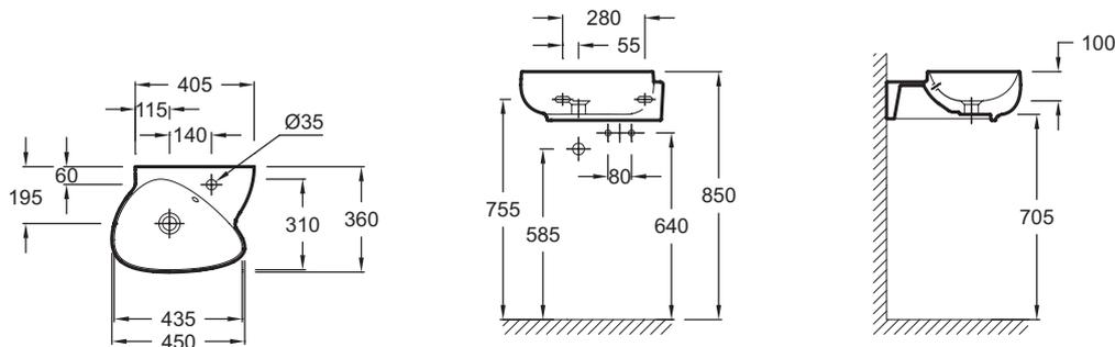
Descriptif CCTP : Lave-mains 45 cm. EGK112. Collection : NOUVELLE VAGUE. DIMENSIONS : 45 x 36 cm. POIDS : 12 kg. MATÉRIAU : Céramique. TYPE D'INSTALLATION : Autoportant. PERCEMENT ROBINETTERIE : 1 trou. TROP-PLEIN : Avec trou de trop-plein. LIVRÉ AVEC : Clapet de bonde. ROBINETTERIE CONSEILLÉE : Nouvelle Vague. INFOS COMPLÉMENTAIRES : Robinetterie non incluse.
