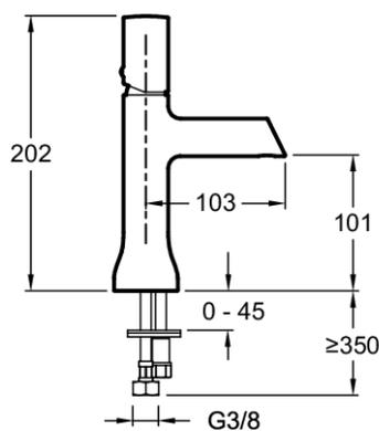
Descriptif CCTP : Mitigeur lavabo. E7329. Collection : TOOBI. POIDS : 1,3kg. MATÉRIAU : Métal. TYPE D'INSTALLATION : 1 trou. TYPE : Mitigeur. DÉBIT (L/MN SOUS 3 BAR) : 8 l/mn. RACCORDS : Avec flexibles d'alimentation. MÉCANISME : Cartouche à disques céramique. VIDAGE : Sans. GARANTIE MÉCANISME : 5 ans.
