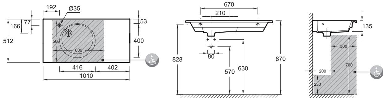
Descriptif CCTP : Plan-vasque 100 cm, meulé. EXAU112-Z. Collection : ODÉON RIVE GAUCHE. DIMENSIONS : 101 x 51,20 cm. POIDS : 28,4 kg. MATÉRIAU : Céramique. TYPE D'INSTALLATION : Autoportant. PERCEMENT ROBINETTERIE : 1 trou. CONFIGURATION : Standard. MEULÉ/NON-MEULÉ : Meulé. TROP-PLEIN : Avec trou de trop-plein. NOMBRE DE VASQUES : 1 cuve. ROBINETTERIE CONSEILLÉE : Odéon Rive Gauche. INFOS COMPLÉMENTAIRES : Bonde et robinetterie non incluses.
