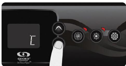
La température de l'eau peut être affichée soit en degrés Celsius (°C), soit en degrés Fahrenheit (°F). L'écran affichera C ou F. Utilisez la touche **Haut/Bas** pour modifier le réglage. Utilisez la touche **Programme** pour sauvegarder tous les paramètres.
