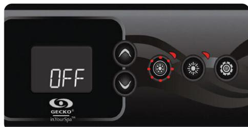
Appuyez sur la touche **Pompe** pour démarrer la pompe à basse vitesse. Appuyez une deuxième fois pour faire passer la pompe en haute vitesse. Une troisième pression met la pompe à l'arrêt, sauf si le spa est en mode chauffe ou filtration. Une minuterie intégrée arrête la pompe automatiquement après 20 minutes, à moins qu'elle n'ait été éteinte manuellement.
