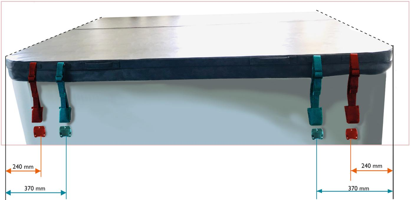
Positionner les attaches en fonction de votre type de tablier et marquer les positions de perçages de vis
