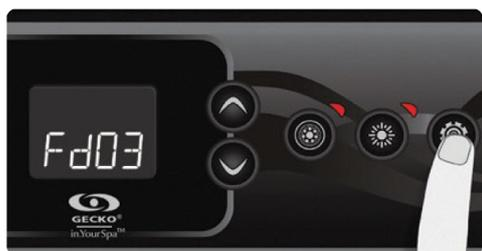
Non disponible sur les systèmes à cycle de purge uniquement. L'écran affichera **Fdxx**, « xx » représentant la durée en heures du cycle de filtration. Utilisez la touche **Haut/Bas** pour ajuster la durée. Utilisez la touche Lumière pour passer au paramètre suivant, la fréquence du cycle de filtration ou de purge (**FF**).
