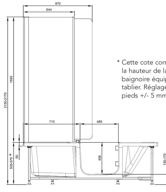
\* Cette cote correspond à la hauteur de la baignoire équipée d'un tablier. Réglage des pieds +/- 5 mm.
