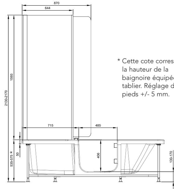
\* Cette cote correspond à la hauteur de la baignoire équipée d'un tablier. Réglage des pieds +/- 5 mm.
